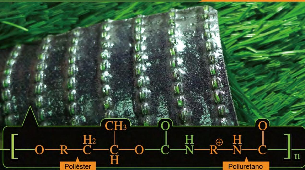
Adhesivo empapado, resistencia excelente al agua y temperatura extrema
